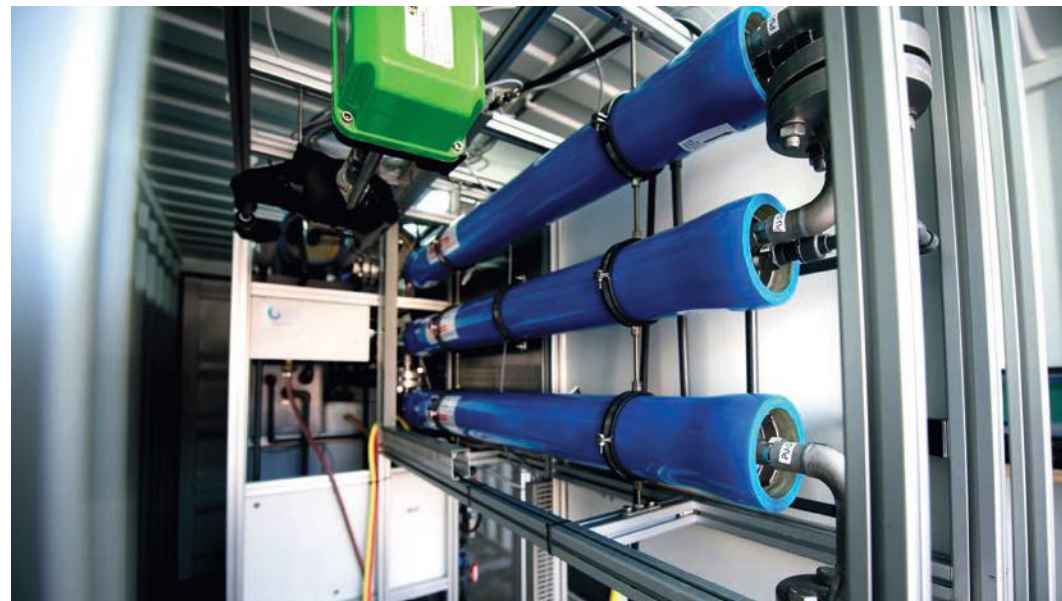
↑ De brine-concentrator-pilot met meertraps nanofiltratiesysteem tot 80 bar.
