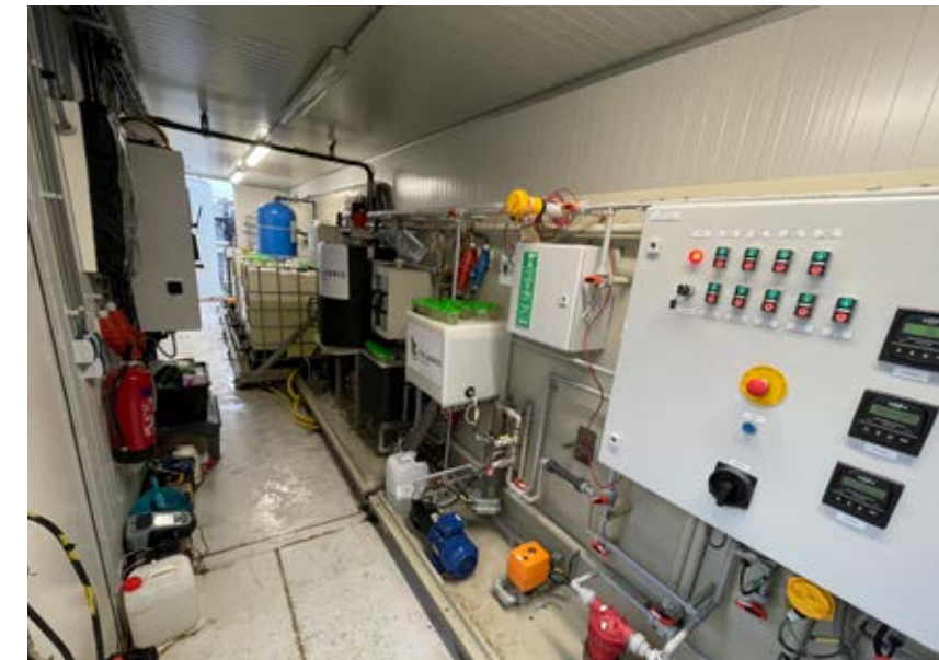
„Die am Klärwerk getestete Technologie ist eine Kombination aus Ionenaustausch und Membranstripping.“
